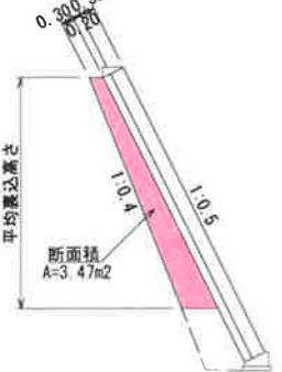
裏込クラッシャーラン断面図 S=1:100
