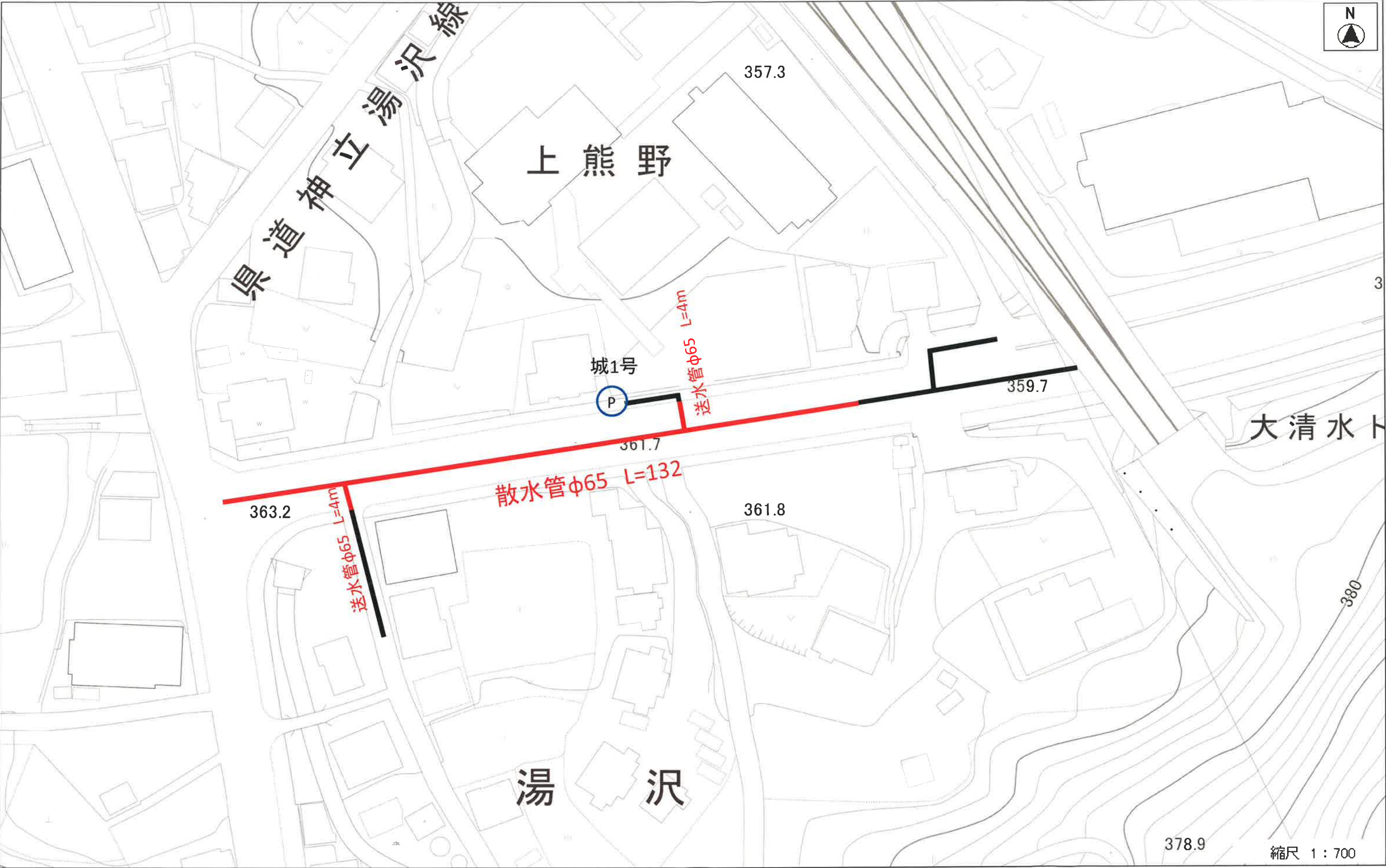
地雪寒第3号 城平線消雪パイプ打替工事 L=140m 平面図
