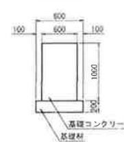
端末支柱基礎断面図 (A-A矢視)
