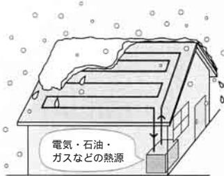
電気、石油、ガス等を用いた熱源により、短期間に融雪する方法
