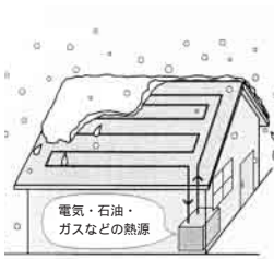
電気、石油、ガス等を用いた熱源により、短期間に融雪する方法
