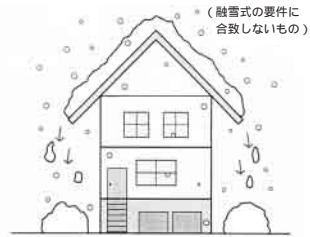
敷地に堆雪スペースを確保し、屋根雪を自然落下させる方法
