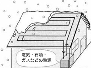
電気、石油、ガス等を用いた熱源により、短期間に融雪する方法
