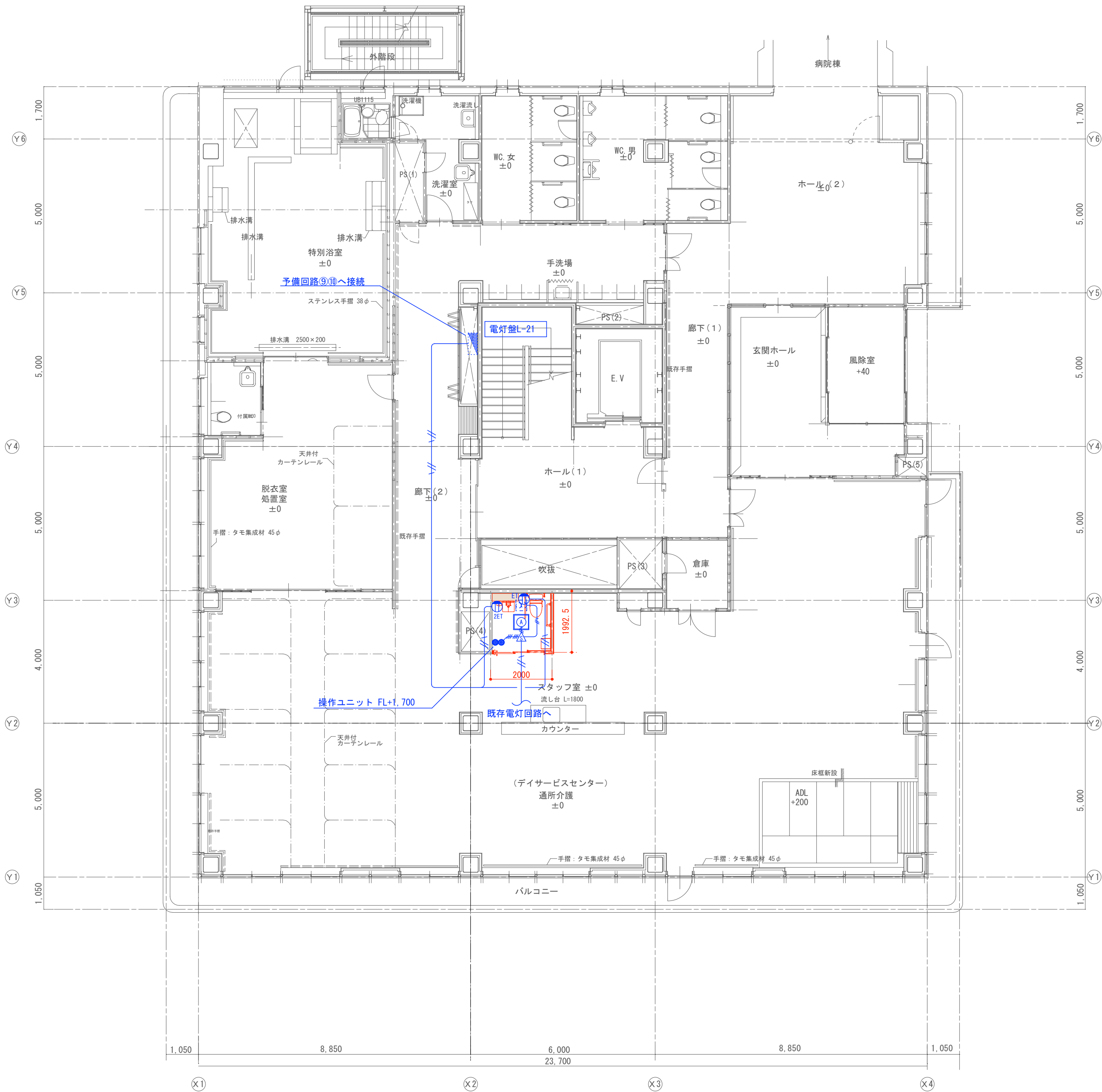
1 階平面図【新設 電灯・コンセント設備図】 S=1:100
