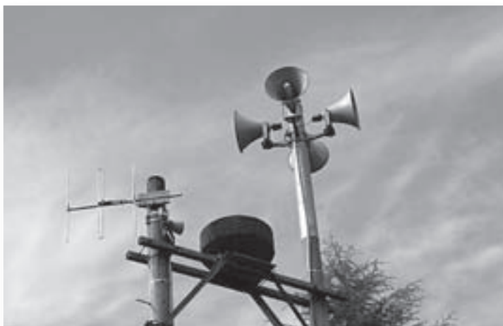
神立地区のサイレン塔に設置されている無線遠隔装置スピーカー
